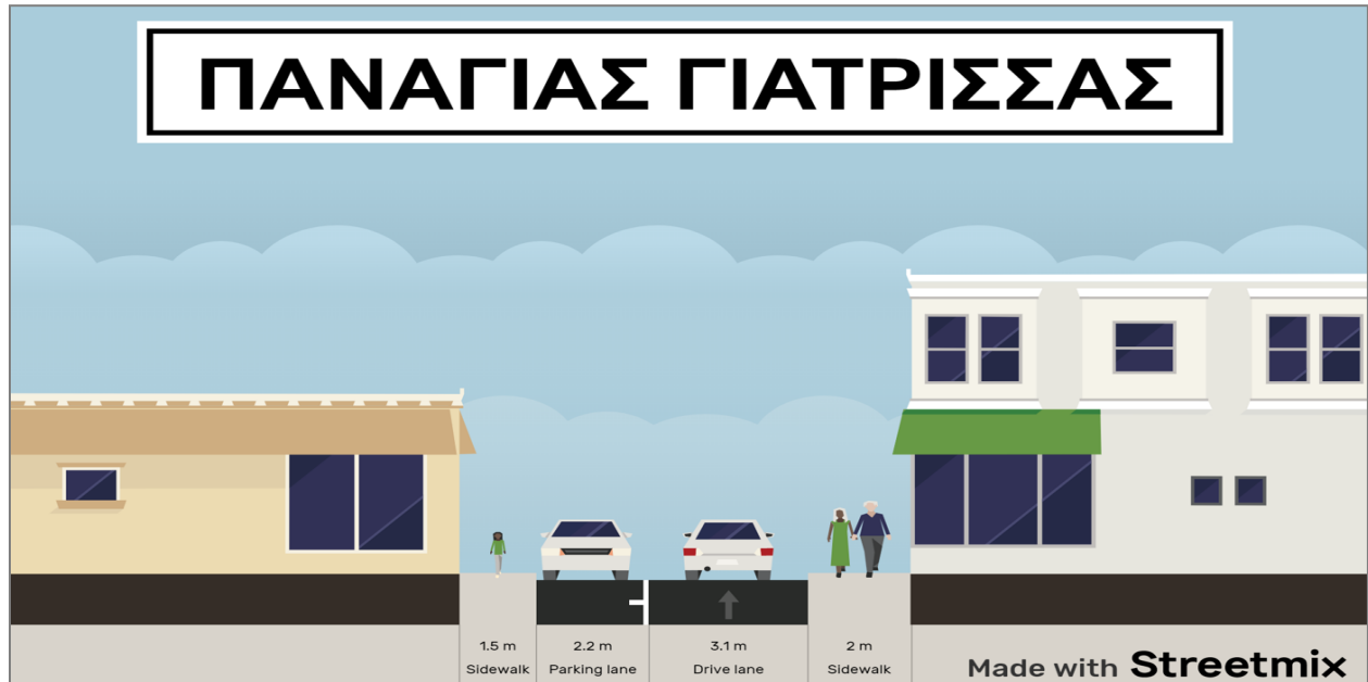
Εικόνα 9: Υφιστάμενη Κατάσταση της οδού Παναγιά Γιάτρισσας (διατομή)
