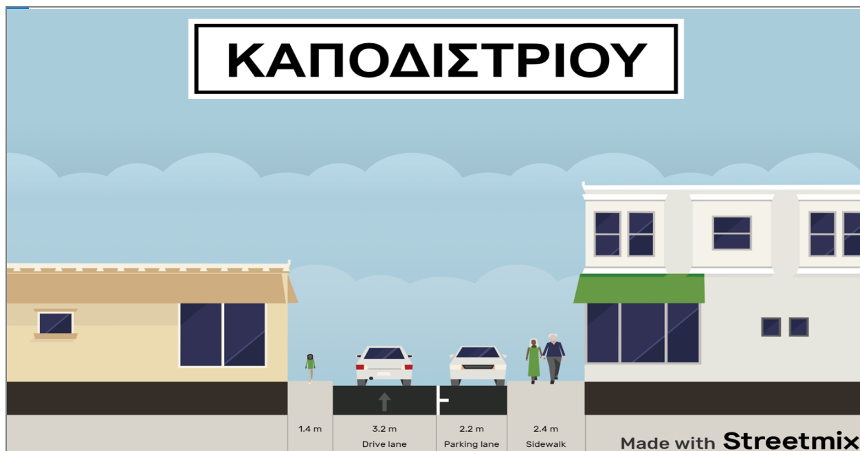
Εικόνα 17: Υφιστάμενη Κατάσταση της οδού Καποδιστρίου (διατομή)
