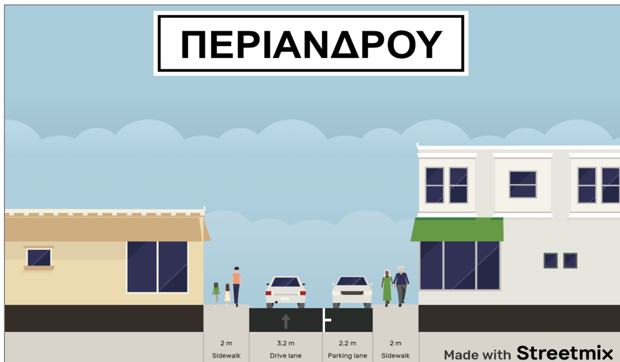
Εικόνα 34: Προτεινόμενη Κατάσταση της οδού Περιάνδρου
