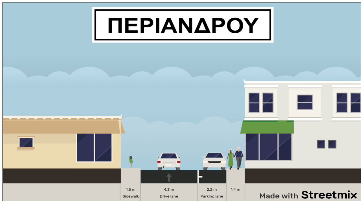
Εικόνα 15: Υφιστάμενη Κατάσταση της οδού Περιάνδρου (διατομή)
